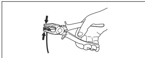
4. Corte el cable delimitador 1-2 cm (0.4-0.8 pulg.) por encima de cada conector.
