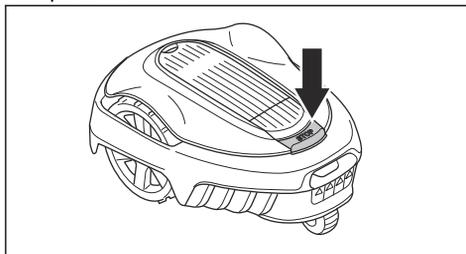
2. Pulse el botón **ON/OFF** durante 3 segundos y asegúrese de que el producto está apagado. Compruebe que la luz indicadora del teclado esté apagada. Esto significa que el producto está desactivado. Consulte la sección *Luz indicadora de la estación de carga en la página 51*.
