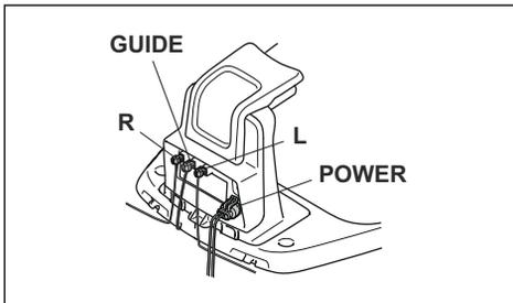
3. Intercambie las conexiones del cable guía y el cable delimitador en la estación de carga.
