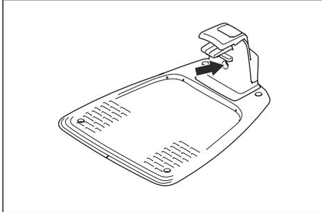
2. Compruebe que las conexiones del cable delimitador a la estación de carga están conectadas correctamente y no están dañadas. Compruebe que la luz indicadora de la estación de carga sigue parpadeando en azul.
