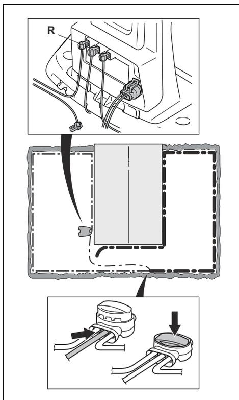
Si la luz indicadora parpadea ahora en amarillo, la rotura está en algún lugar del cable entre el extremo desconectado y el punto donde se conecta el cable nuevo (la siguiente línea negra y gruesa). En ese caso, acerque la conexión del cable nuevo a la punta desconectada (más o menos, en la mitad de la sección del cable que podría estar dañada) y vuelva a comprobar si la luz indicadora está en verde.
