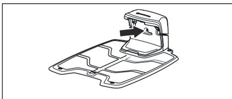
2. Verificare che i collegamenti del cavo perimetrale alla stazione di ricarica siano effettuati correttamente e non siano difettosi. Verificare che la spia della stazione di ricarica sia ancora blu e lampeggiante.
