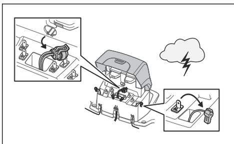
Per ridurre il rischio di danni ai componenti elettrici del prodotto e della stazione di ricarica, si consiglia di scollegare tutte le connessioni alla stazione di ricarica (alimentazione, cavo perimetrale e cavi guida) in caso di rischio di temporali.
