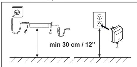
5. Collegare il cavo di alimentazione a una presa da 100-240 V.
