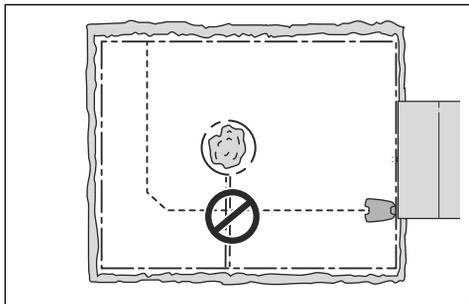
Per creare un'isola, isolare le parti dell'area di lavoro con il cavo perimetrale. Si consiglia di isolare tutti gli oggetti stabili nell'area di lavoro.
