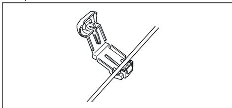
3. Chiudere il connettore usando un paio di pinze.
