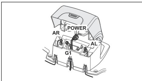
3. Invertire i collegamenti tra il cavo guida e il cavo perimetrale sulla stazione di ricarica.
