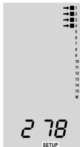
1. Appuyez sur la touche **Setup** (par exemple avec une mine de stylo à bille) pour afficher le mode d'enregistrement de la télécommande.
