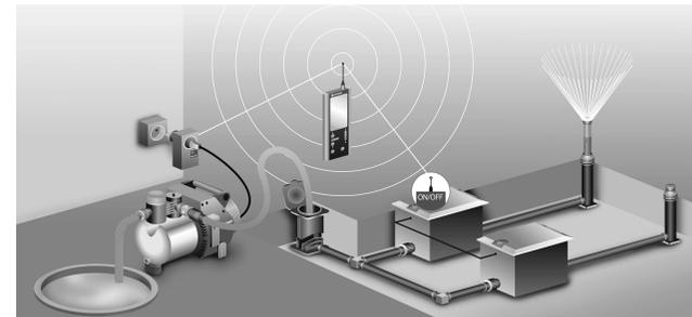
Les signaux de commande sont transmis par radio aux récepteurs. L'échange régulier des données entre la télécommande et les récepteurs garantit une haute sécurité fonctionnelle.
