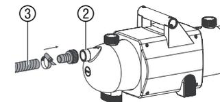
1. Pour placer la pompe **sous l'eau**, vissez le **filtre** ① au raccord ② côté aspiration
