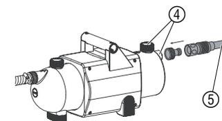
Les deux embouts de sortie ④ ont un filetage extérieur 26/34 sur lequel vous pouvez brancher des tuyaux Ø int. 13 mm, 15 mm ou 19 mm en utilisant les éléments de raccordement GARDENA.
