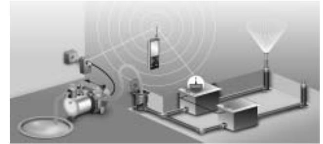
Die Steuersignale werden an die Empfänger übertragen. Durch einen regelmäßigen Datenaustausch zwischen Funkzentrale und Empfänger ist eine hohe Funktionssicherheit gewährleistet. Andere 433-MHz-Geräte (z. B. Garagentor-Öffner) oder weitere Funkzentralen (z. B. die des Nachbarn) beeinflussen sich gegenseitig nicht.
