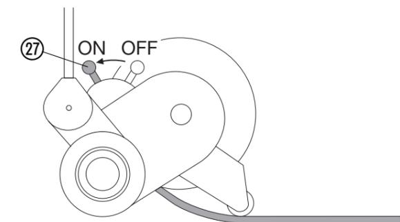
**D** Arbeitsschlauch <sup>28</sup> seitlich auf das Hahnanschluss-Stück <sup>14</sup> stecken und bei **gesenktem** Griffbügel <sup>22</sup> aufwickeln.
