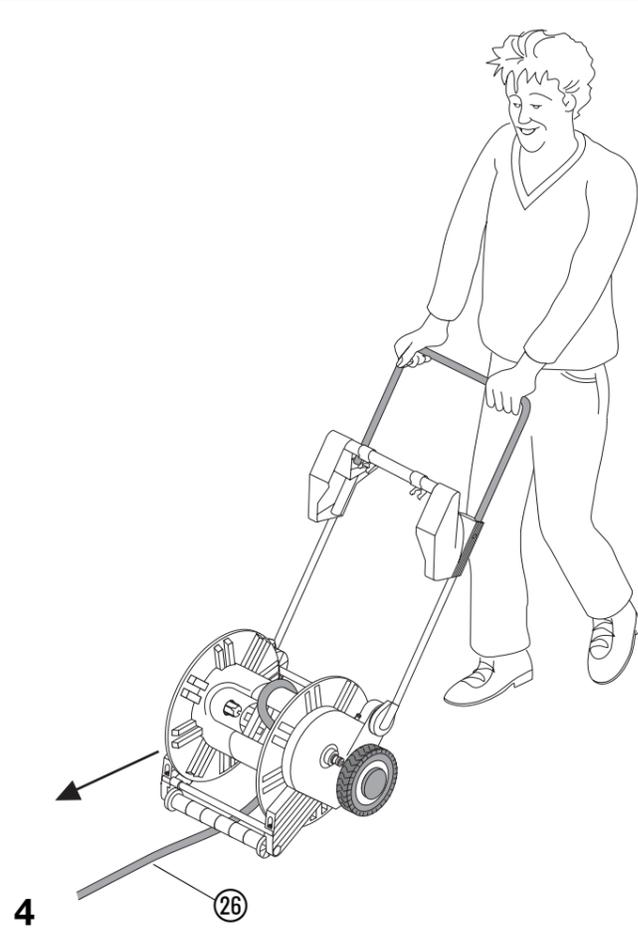
**D** Schlauchmobil **über den Gartenschlauch** <sup>26</sup> ziehen.
