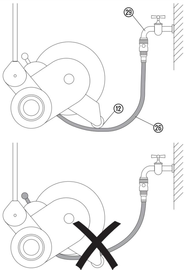
**D** Hebel <sup>27</sup> auf Stellung **ON** stellen, damit die Trommel angetrieben wird.
