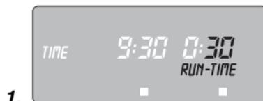
1. **man. On/Off**-Taste drücken, um das Ventil manuell zu öffnen (bzw. ein geöffnetes Ventil zu schließen).
