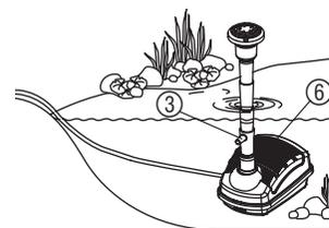
1. Installez la pompe sur une surface solide de façon que le boîtier filtre ⑥ soit entièrement recouvert d'eau.
