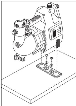
A szivattyút stabil felállításához és elcsúszás elleni biztosításához csavarozza rá a mellékelt rögzítőlemezt egy megfelelő talapzatra.
