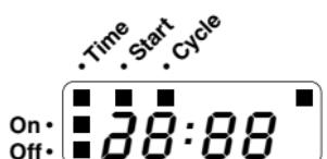
Caso a tensão da bateria baixe até um determinado valor, é mostrado no display **Batt.** Regas manuais podem ser realizadas mesmo com a bateria com pouca carga (válvula não abre mais). Regas programadas, porém, não são executadas.
