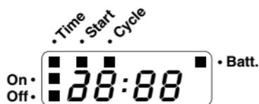
Lorsque la pile devient trop faible, le témoin d'usure de la pile **Batt.** apparaît. Par sécurité, la pile assure de toute façon la dernière fermeture de la vanne, notamment si une ouverture de la vanne a été déclenchée manuellement. En revanche,
