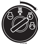
Motor en posición "ON" (Operación Normal)
