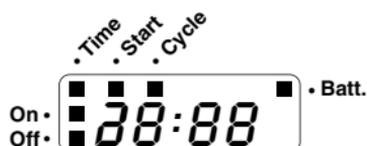
Si la pila no alcanza una **tensión determinada**, aparece la indicación **Batt.** Los riegos manuales se pueden realizar también con carga insuficiente de la pila (**Off**), pero los riegos programados ya no son ejecutados. Incluso con una **capacidad insuficiente de la pila** se cierra de nuevo la válvula abierta.
