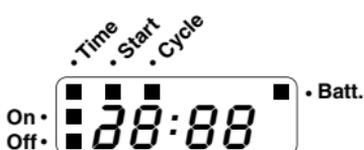
Wird eine **bestimmte Batteriespannung** unterschritten, erscheint die Anzeige **Batt.** Einmal gestartete manuelle Bewässerungen können auch bei zu geringer Batteriekapazität wieder beendet werden (**Off**), programmierte Bewässerungszeiten
