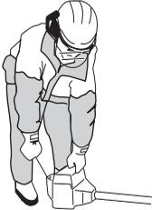
**UWAGA!** Nigdy nie dotykaj żadną częścią ciała do oznaczonej powierzchni. Dotknięcie może spowodować oparzenie ciała lub porażenie prądem, jeżeli nasadka świecy zapłonowej jest uszkodzona. Używaj zawsze rękawic. Nigdy nie używaj maszyny z uszkodzoną nasadką świecy zapłonowej.
