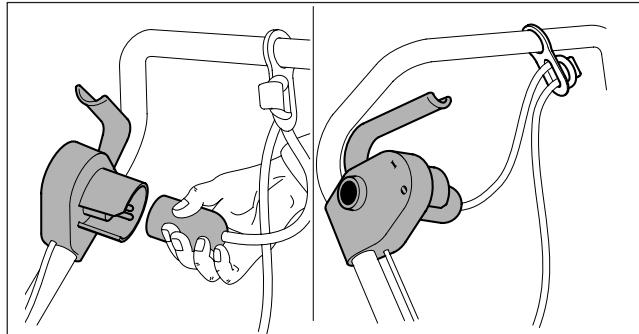
Przed podłączeniem kosiarki do sieci elektrycznej sprawdzić czy w sieci jest zamontowane urządzenie do automatycznego odłączenia prądu w wypadku niebezpieczeństwa zagrożającego życiu osoby obsługującej kosiarkę. Po wykonaniu tych czynności uruchomić silnik w następujący sposób:
