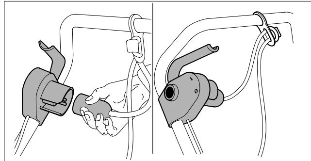
Prima di collegare elettricamente la rasaerba, accertarsi che la rete elettrica sia dotata di salvavita quindi avviare il motore nel seguente modo:
