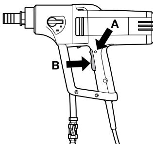
Le blocage de l'interrupteur reste enfoncé tant que l'interrupteur est enfoncé. Quand la poignée est relâchée, l'interrupteur et le blocage de l'interrupteur reviennent en position initiale. Ce retour s'effectue grâce à deux systèmes de ressorts de rappel indépendants l'un de l'autre. Dans cette position, la machine s'arrête et l'interrupteur se bloque.
