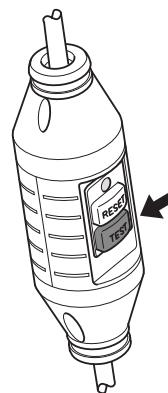
El interruptor de circuito de pérdida a tierra se activará y la máquina se apagará inmediatamente. En caso contrario, póngase en contacto con su distribuidor.
