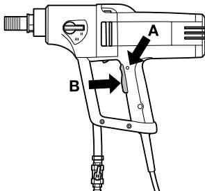
El bloqueador de interruptor permanece presionado mientras está presionado el interruptor. Cuando se suelta la empuñadura, se restablece el interruptor y el bloqueador de interruptor. Esto se hace con dos sistemas de muelle de retorno independientes. Con esta posición, la máquina se para y se bloquea el interruptor.
