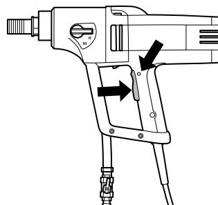
Vérifiez que l'interrupteur et le blocage de l'interrupteur fonctionnent facilement.
