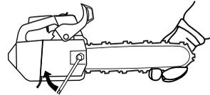
La tension d'une chaîne neuve doit être vérifiée fréquemment pendant son rodage. Vérifier régulièrement la tension. Une tension correcte est synonyme de bonne capacité de coupe et de longue durée de vie.
