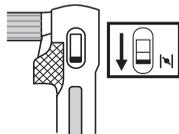
**Pompe à carburant:** Appuyer sur la poche en caoutchouc de la pompe à carburant plusieurs fois jusqu'à ce que le carburant commence à remplir la poche. Il n'est pas nécessaire de remplir la poche complètement.
