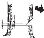
Scier à plein régime et enfoncer graduellement le guide-chaîne dans le tronc. Attention si l'arbre se déplace dans le sens opposé au sens de chute choisi. Introduire un coin ou un bras de levier dans le trait de chute dès que la profondeur de coupe le permet.
