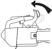
Dévisser l'écrou du guide-chaîne et retirer le carter d'embrayage (frein de chaîne). Déposer la protection de transport.
