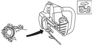
S'assurer que la face tranchante des dents est vers l'avant sur le dessus du guide.
