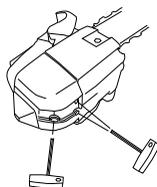
Certains silencieux sont munis d'une grille antiflamme. Cette grille doit être nettoyée une fois par semaine si la machine en est équipée. Utiliser de préférence une brosse en acier. Un pare-étincelles colmaté risque de causer la surchauffe du moteur et de provoquer de sérieuses avaries du moteur.
