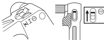
Le moteur est arrêté en poussant l'interrupteur d'arrêt en position d'arrêt.
