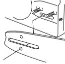
Tendre la chaîne en tournant la vis du tendeur de chaîne vers la droite à l'aide de la clé universelle. Tendre la chaîne jusqu'à ce qu'elle ne pende plus sous le guide. Voir les instructions à la section Tension de la chaîne.
