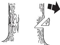
L'encoche doit faire 1/4 du diamètre du tronc et l'angle entre les deux entailles doit être d'au moins 45°.
