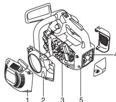
Nettoyer le système de refroidissement avec une brosse une fois par semaine, voire plus souvent dans des conditions difficiles. Un système de refroidissement sale ou colmaté provoque la surchauffe de la machine, endommageant le cylindre et le piston.
