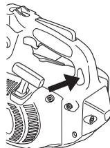
b) utilisez des mousquetons adéquats pour permettre une attache indirecte (via l'estrope) et une attache directe (au point d'attache de la tronçonneuse) de la tronçonneuse au harnais de l'utilisateur.
