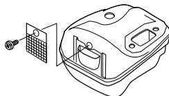
Le silencieux est conçu pour atténuer le bruit et dévier le flux des gaz d'échappement loin de l'utilisateur. Ces gaz sont chauds et peuvent transporter des étincelles risquant de causer un incendie si elles entrent en contact avec un matériau sec et inflammable.
