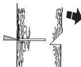
Le trait de chute doit s'achever parallèlement à l'encoche, l'espace entre les deux étant 1/10 du diamètre du tronc. La partie non coupée du tronc s'appelle la charnière.
