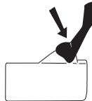
Actionner l'arceau d'avant en arrière pour s'assurer qu'il se meut librement et qu'il est solidement fixé à son articulation dans le carter d'embrayage.
