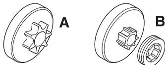
Vérifier régulièrement le degré d'usure du pignon. Le remplacer en cas d'usure excessive. Le pignon doit être remplacé en même temps que la chaîne.
