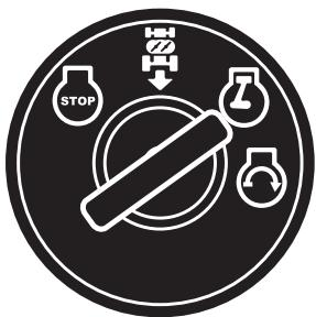
DE Nach Anspringen des Motors den Zündschlüssel in die Stellung "ON" zurückgehen lassen. Den Gashebel auf die gewünschte Motordrehzahl stellen. Bei Mähen: Vollgas.
