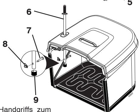
6. Rohr des Handgriffs zum Entleeren der Grasfangbox
