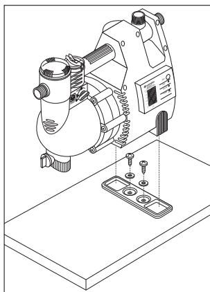
Um die Pumpe standsicher aufzustellen und gegen Verrutschen zu sichern, schrauben Sie die beiliegende Befestigungsplatte auf eine geeignete Unterlage.
