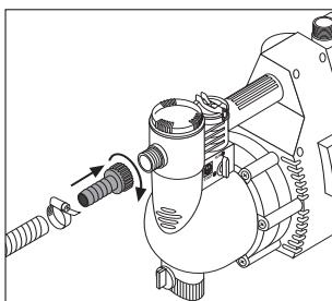
Schrauben Sie die GARDENA Sauggarnitur (Art.-Nr. 1411/1418) auf die Saugseite der Pumpe und ziehen Sie sie von Hand fest an, bis der Dichtring satt angepresst wird. Bringen Sie nun den Saugschlauch in das zu fördernde Medium ein.
