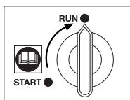
Stellen Sie, sobald die Pumpe fördert, den Drehschalter auf **RUN** (Normalbetrieb) → Gewährleistung eines störungsfreien Pumpbetriebes.
