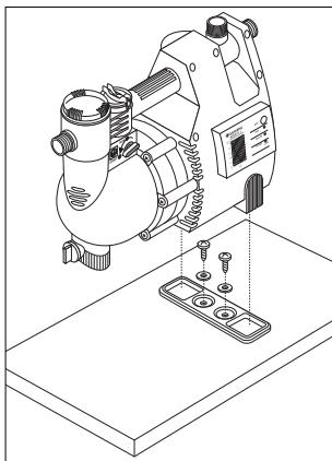
Vissez la plaque de fixation fournie sur un support approprié pour assurer une installation stable de la pompe et l'empêcher de glisser.
