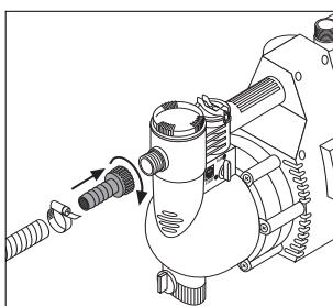
Vissez l'équipement d'aspiration GARDENA (réf. 1411/1418) sur le côté aspiration de la pompe et vissez fermement à la main jusqu'à ce que la bague d'étanchéité soit bien serrée. Plongez maintenant le tuyau d'aspiration dans le liquide à aspirer.
