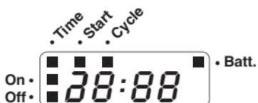
Caso a tensão da bateria baixe até um determinado valor, é mostrado no display **Batt.** Regas manuais podem ser realizadas mesmo com a bateria com pouca carga (válvula não abre mais). Regas programadas, porém, não são executadas.
