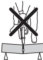
Si el disco se atasca o se engancha en el sector de riesgo de reculada, la fuerza reactiva empujará la cortadora hacia arriba y hacia atrás en dirección al usuario con un
