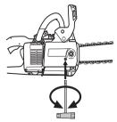
Avec la clé universelle, serrer les écrous du guidechaîne tout en tenant levé le nez du guide. S'assurer que la chaîne peut tourner manuellement et ne pend pas sous le guide.
