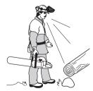
Observer la plus grande prudence lors de l'abattage des arbres sous tension. Avant et après le sciage, les arbres sous tension risquent de brutalement retrouver leur position initiale. Un mauvais placement de l'utilisateur ou de l'entaille d'abattage peut entraîner un choc avec l'arbre pouvant résulter en une chute ou en une perte du contrôle de la machine. Ces deux cas
