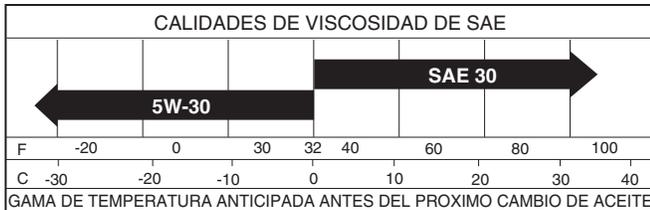
**AVISO:** A pesar de que los aceites de multiviscosidad (5W30, 10W30, etc.) mejoran el arranque en clima frío, estos aceites de multiviscosidad van a aumentar el consumo de aceite cuando se usan en temperaturas sobre 32° F (0° C). Revise el nivel del aceite del motor más a menudo, para evitar un posible daño en el motor, debido a que no tiene suficiente aceite.
