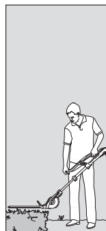
Taglio ribassato: Testina di taglio inclinata di -45°, tubo telescopico prolungato.
