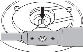
Monteer de sluitring en draai de bout en ring goed vast. De bout moet worden vastgedraaid met een moment van 45-60 Nm.
