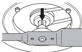
Ajuste la arandela del muelle y apriete el perno y la arandela adecuadamente. El perno debe apretarse con un par de 45-60 Nm.
