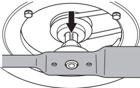
Inserire la rondella reggispinta e serrare correttamente bullone e rondella. Il bullone va serrato con una coppia di 45-60 Nm.
