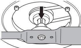
Positionnez la rondelle élastique et serrez correctement le boulon et la rondelle. Le boulon doit être serré au couple de serrage de 45-60 Nm.
