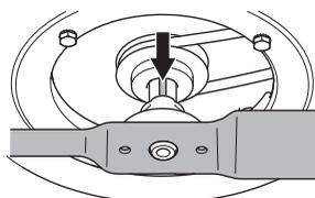
Założyć podkładkę sprężynową i prawidłowo dokręcić śrubę. Śruba musi zostać dokręcona momentem 45–60 Nm.
