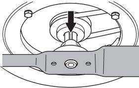
Den Federring anbringen und die Schraube und die Scheibe korrekt festziehen. Die Schraube muss mit einem Drehmoment zwischen 45 und 60 Nm festgezogen werden.
