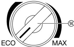
Um Energie zu sparen (bis 15 %) kann, je nach Einsatzfall, der Abschaltdruck der Pumpe stufenlos zwischen **ECO** und **MAX** reguliert werden. (Die Druckdifferenz zwischen **ECO** und **MAX** beträgt ca. 1 bar.)
