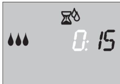
**Programma d'emergenza (sensore lampeggiante):** se non è inserito nessun sensore o nel caso in cui il cavo del sensore fosse difettoso, l'irrigazione avverrà una volta al giorno per la durata di irrigazione impostata (max. 30 min.).
