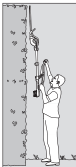
Høj lodret klipning: Teleskoprør forlænget.
