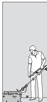
Lav klipning: Skærehoved hælder 45°, teleskoprør forlænget.
