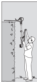
Høj vandret klipning: Skærehoved hælder 75°, teleskoprør forlænget.
