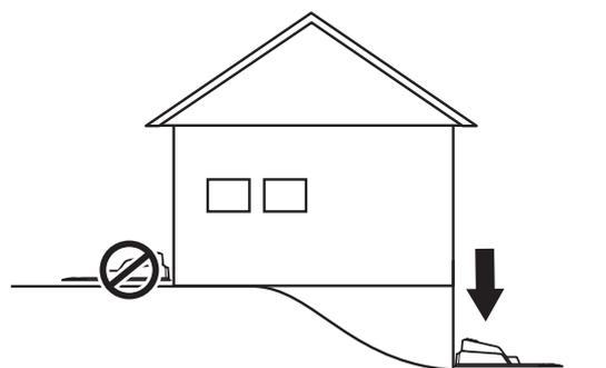
La station de charge ne doit pas être placée sur un îlot, car ceci limiterait les possibilités de mise en place du câble guide. Si elle doit impérativement être installée sur un îlot, le câble guide devra également être connecté à l'îlot. Voir la figure en face. Pour en savoir plus sur les îlots, rendez-vous au chapitre 3.4 *Installation du câble périphérique* en page 21.
