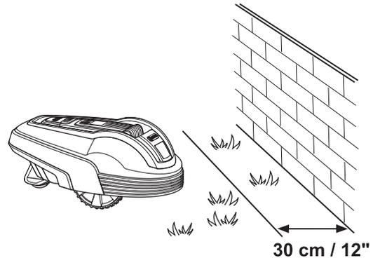
Si la zone de travail est délimitée par un petit fossé, une plate-bande par exemple, ou une petite surélévation, un rebord en pierres basses par exemple (3 à 5 cm), le câble périphérique doit être placé à 20 cm à l'intérieur de la zone de travail. De cette manière, les roues ne risquent pas de basculer dans le fossé ou de monter sur le rebord.
