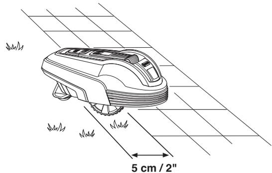
Si la zone de travail est divisée par une allée dallée de même niveau que la pelouse, il est possible de laisser la tondeuse robot traverser l'allée. Le câble périphérique peut très bien être posé sous les dalles. Il est également possible de loger le câble périphérique dans les rainures entre les dalles.
