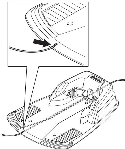
2. Branchez le connecteur au câble guide de la même façon que le câble périphérique, conformément au chapitre 3.5 *Connexion du câble périphérique* en page 27. Branchez-le sur la broche de la station de charge indiquant « guide ».
