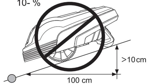
Par contre, s'il existe un obstacle contre lequel la tondeuse robot peut être autorisée à buter, par exemple une clôture ou une haie touffue, le câble périphérique peut être posé en travers d'une pente d'une inclinaison supérieure à 10 %.
