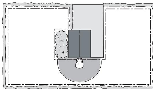
Ne placez pas la station de charge dans un espace confiné de la zone de tonte. Le câble périphérique doit sortir en ligne droite sur au moins 1,5 mètre de long, à droite et à gauche de la station de charge. Le câble doit être positionné en ligne droite depuis l'arrière de la station de charge. Tout autre positionnement obligerait la tondeuse robot à pénétrer dans la station de charge par le côté en rendant difficile son arrimage.
