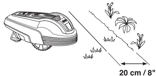
Si la zone de travail est contiguë à une allée au même niveau que la pelouse, il est possible de laisser la tondeuse robot s'avancer quelque peu sur cette allée. Le câble périphérique doit être placé à 5 cm du bord de l'allée.
