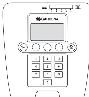
Si le bouton STOP est actionné et que le couvercle est ouvert, la fenêtre de fonctionnement affiche l'horloge, le mode de fonctionnement sélectionné, le nombre d'heures de tonte, l'état de la batterie et le réglage de la minuterie.
