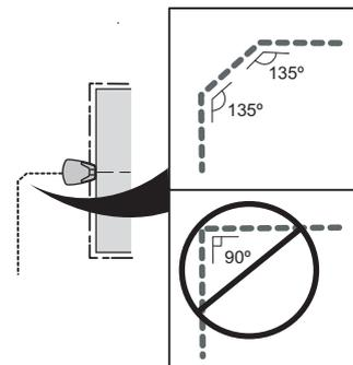
Insérez le câble périphérique dans chaque trou du raccord. Insérez le câble guide dans l'orifice central du raccord. Vérifiez si les câbles sont bien insérés complètement dans le raccord de sorte que les extrémités soient visibles à travers la zone transparente de l'autre côté du raccord.
