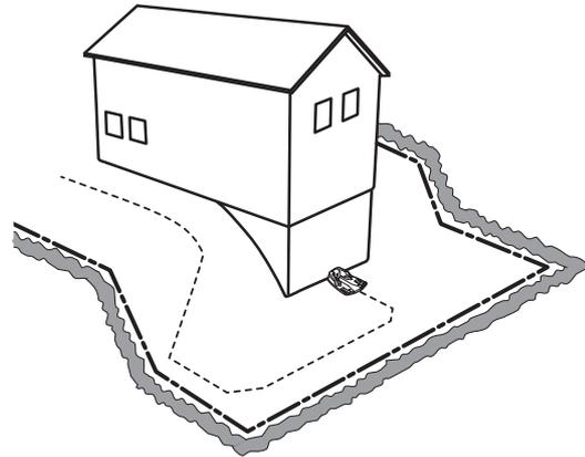
Évitez de placer le câble dans des angles pointus. Il peut ainsi être difficile pour la tondeuse robot de suivre le câble guide.
