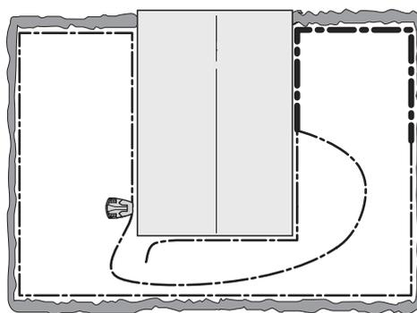
5. Une fois la coupure trouvée, la partie endommagée doit être remplacée par un nouveau câble. La partie endommagée peut être découpée s'il est possible de raccourcir le câble périphérique. Utilisez toujours des raccords d'origine.
