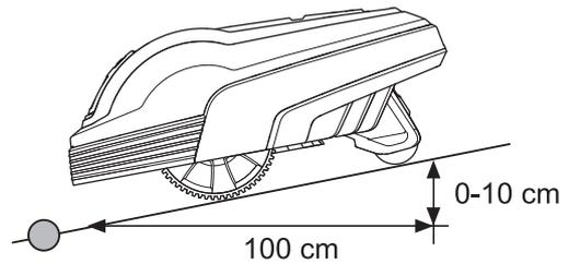
Le câble périphérique ne doit pas être posé en travers d'une pente d'une inclinaison supérieure à 10 %. La tondeuse robot aurait du mal à tourner. La tondeuse robot s'arrête et affiche le message d'erreur *En dehors zone de tonte*. Le risque est particulièrement important par temps humide dans la mesure où les roues risquent de dérapier dans l'herbe mouillée.
