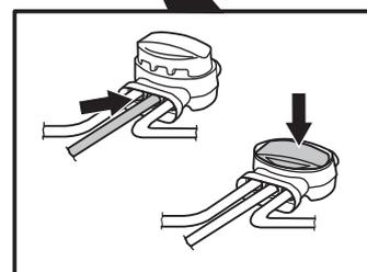
Dans ce cas, déplacez la connexion destinée au nouveau câble plus près de l'extrémité débranchée (en gros, au milieu de la partie du câble suspectée) puis recontrôlez si le voyant est vert ou clignote en jaune.
