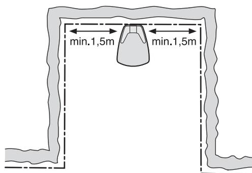
Ne placez pas la station de charge dans un angle de la zone de tonte. Le câble périphérique doit sortir en ligne droite sur au moins 1,5 mètre de long, à droite et à gauche de la station de charge.
