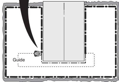
b) Remplacez les connexions A1 et Guide sur leurs positions d'origine. Puis intervertissez les connexions A2 et Guide.
