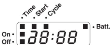
Ha az elem feszültsége egy **meghatározott érték** alá csökken, megjelenik a **Batt.** kijelzés. A már elindított kézi öntözést akkor is be lehet fejezni, ha az elem kapacitása túl alacsony (**Off**), de a programozott öntözési idők többé nem kerülnek végrehajtásra. Túl alacsony elemkapacitásnál a kinyitott szelep újra lezár.
