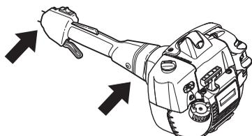
Le système anti-vibrations réduit la transmission des vibrations de l'unité moteur/l'équipement de coupe à l'unité que constituent les poignées.
