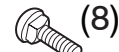
(8) 3/8-16 x 1 Carriage Bolts Karoserieschrauben Boulons de carrosserie Tornillos de cabeza redonda Bulloni a testa tonda Slotbouten
