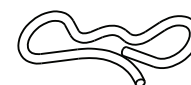
Retainer Spring Clip Federklammer-Sicherung Attache à ressort Abrazadera de arandela de retención Clip di fissaggio Sluitveerklem
