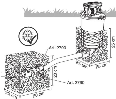
**D** Regner ebenerdig einbauen. Somit ist eine Beschädigung durch einen Rasenmäher ausgeschlossen. Frostsicher mit Entwässerungsventil Art. 2760. Zur Drainage in eine Sickerpackung aus Grobkies einbauen.
