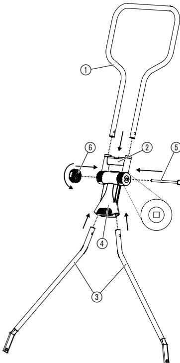
1. Untere Holmaufnahme ④ in die obere Holmaufnahme ② einschieben (schon vormontiert).
