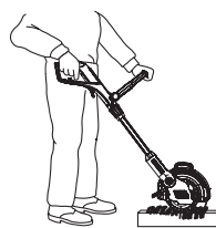
Position de travail 3 : Élagage vertical des finitions de bordures
