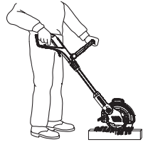
Arbeitsposition 3: Senkrecht Trimmen überhängender Rasenkanten
