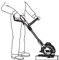
Werkpositie 3: Vertikaal trimmen van overhangende graskanten
