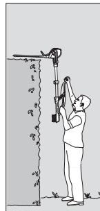
Ψηλή οριζόντια κοπή: Μονάδα μοτέρ με κλίση κατά 75°, τηλεσκοπικός σωλήνας με επέκταση
