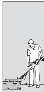
Χαμηλή κοπή: Μονάδα μοτέρ με κλίση κατά -60°, τηλεσκοπικός σωλήνας με επέκταση
