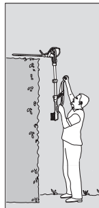
Visoko horizontalno rezanje: Jedinica motora nagnuta za 75°, produžena teleskopska cijev
