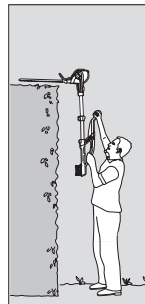
Cięcie wyższych, poziomych żywopłotów: Zespół silnika pochylony o 75°, uchwyt telesko- powy wysunięty
