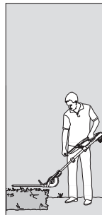
Nizko rezanje: Enota motorja nagnjena za -60°, teleskopska cev je podaljšana
