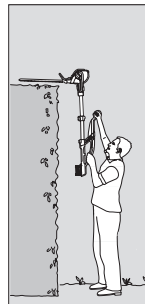
Horizontálny strih vo výške: Motorová jednotka naklonená o 75°, teleskopická rúrka predĺžená
