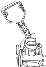
De handgreep kan ook in hoogte worden versteld door te draaien aan de knoppen bij de bevestigingen op het chassis.
