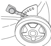
Ne pas régler la hauteur de coupe trop bas afin que la machine ne se cogne contre le sol en cas d'irrégularités de terrain.
