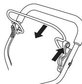
El freno de motor debe estar siempre ajustado para que el motor separe en un lapso de 3 segundos.
