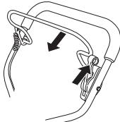
Il freno del motore deve sempre essere regolato in modo che il motore si arresti entro 3 secondi.
