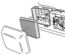
Luftfilter entfernen und prüfen, dass er intakt ist. Bei Defekten einen neuen Luftfilter einsetzen.
