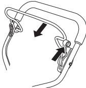
Le frein moteur doit toujours être réglé de manière à ce que le moteur s'arrête dans les 3 secondes.
