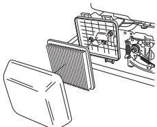
Αφαιρέστη το φίλτρο αέρα και ηλέγχητη ότι δην παρουσιάζη βλάβης. Αντικαταστήστη μηνέ νέο φίλτρο αέρα, αν πιστήνητη ότι ήναι ηλαττωματικό.
