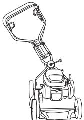
Il manubrio può anche essere regolato in verticale girando le ruote presso il punto di fissaggio sul telaio
