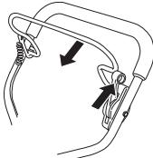
Die Motorbremse muss stets so eingestellt sein, dass der Motor innerhalb von 3 Sekunden stoppt.
