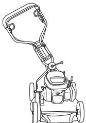
La poignée peut également être réglée en hauteur au châssis en faisant tourner les roues.
