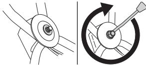
Bei Bedarf kann der Handgriff etwas zur Seite gedreht werden. Der Handgriff lässt sich in verschiedene Positionen verstetllen, um z. B. bei Arbeiten an Hecken oder Hauswänden die optimale Fahrstellung zu erzielen.
