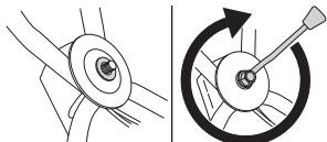
Se necessário, o punho pode ser rodado ligeiramente para o lado pela união do punho. O punho pode ser colocado em diversas posições, de modo a conseguir-se a melhor posição de condução, p.ex. para cortar a relva junto de sebes ou paredes.
