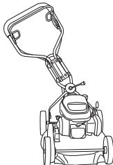
El mango también se puede ajustar verticalmente girando las ruedas con el elemento de enganche del chasis.
