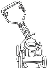
Der Handgriff lässt sich auch in der Höhe verstetllen, indem die Drehräder an den Befestigungen am Fahrgestell angepasst werden.
