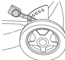
No emplee una altura de corte demasiado baja debido al riesgo de que las cuchillas toquen en el suelo en las irregularidades.
