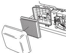
Retire o filtro de ar e verifique que não se encontra danificado. Substitua com um novo filtro de ar caso tenha determinado que está danificado.
