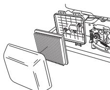
Verwijder het luchtfILTER en controleer of het heel is. Vervang door een nieuw luchtfILTER wanneer u merkt dat het gebreken vertoont.
