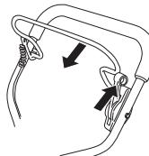
De motorrem moet altijd zo afgesteld zijn dat de motor binnen 3 seconden start.
