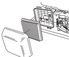
Togliere il filtro dell'aria e controllare che sia integro. Sostituire il filtro se vi sembra difettoso.
