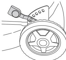
Não regule a altura de corte para demasiado baixo, devido ao risco de a lâmina poder embater em irregularidades no terreno.
