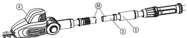
1. Teleskoprohr ③ bis zum Anschlag in die Motoreinheit ④ schieben. Dabei müssen sich die beiden Markierungen (M) gegenüberliegen.
