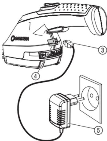
1. Encaixar o cabo de carregamento ③ na tomada fêmea ④ da tesoura com bateria.
