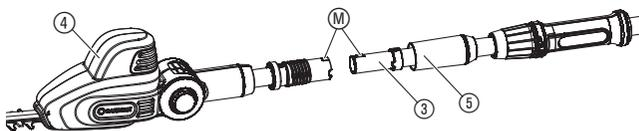
1. Glisser le tube télescopique ③ dans le moteur ④ jusqu'à la butée. Pour cela, les deux marques (M) doivent être l'une en face de l'autre.
