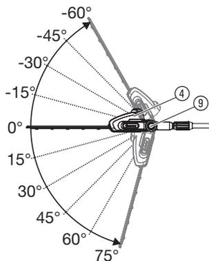
Pour une coupe haute et basse, il est possible d'incliner l'unité moteur (4) par pas de 15°, de 75° à -60°.
